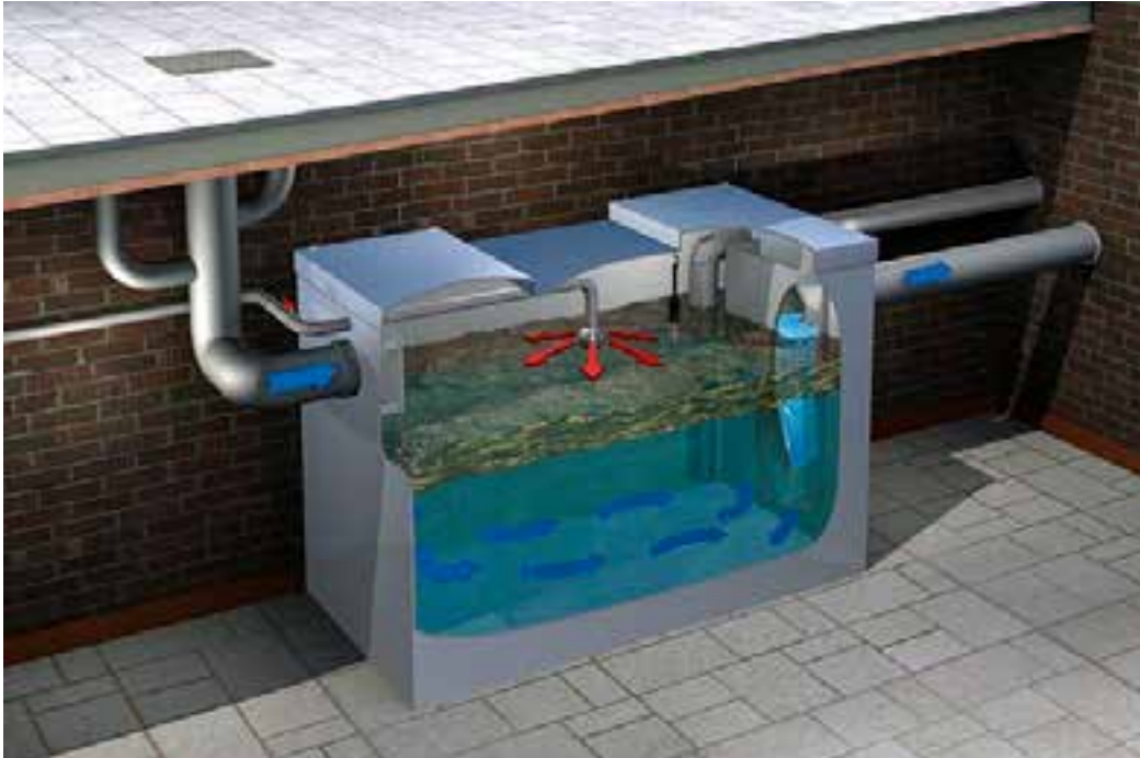
Prinsippskisse fettutskiller med spylefunksjon for rengjøring. Kilde: www.odin-maskin.no
